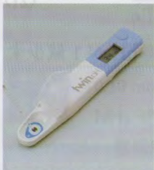
pHメーター 水溶液中にガラス電極を浸すと、pHの値が表示される。
