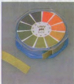
pH試験紙 色の変化により、pHのおよその値がわかる。
