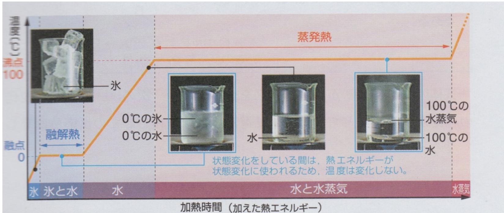
図 10 状態変化と熱(再掲) 大気圧のもとで氷に熱エネルギーを加えていくときのようす
