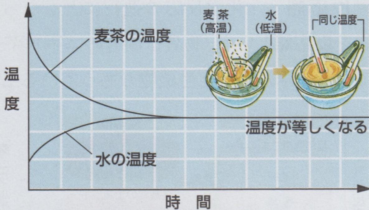
図2 熱の移動と水の温度変化
